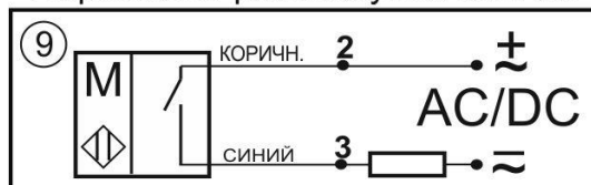
Схема подключения Нормально-разомкнутый контакт
