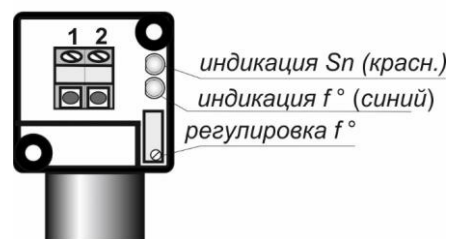
Цоколевка клеммной колодки
