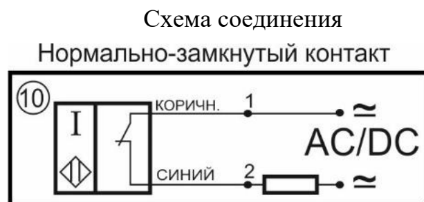
Цоколевка клеммной колодки
