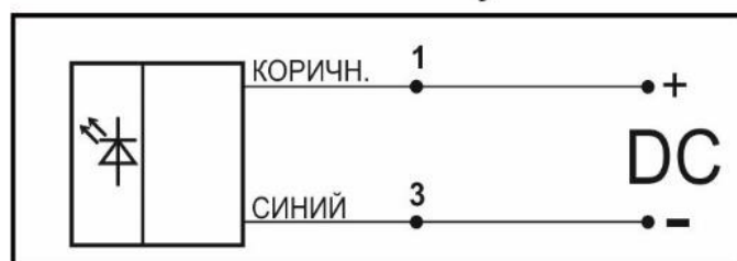
Схема соединения оптического излучателя
