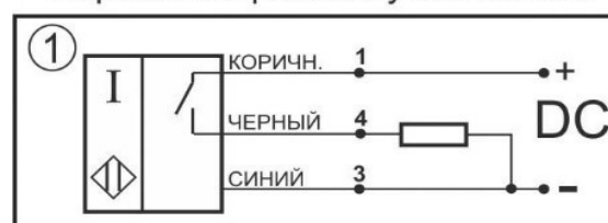
Схема соединения Нормально-разомкнутый контакт
