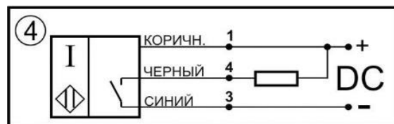
Схема соединения Нормально-разомкнутый контакт
