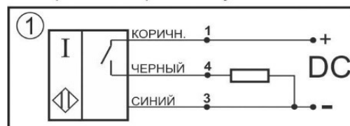
Цоколевка клеммной колодки
