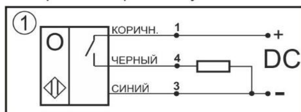
Схема соединения Нормально-разомкнутый контакт
