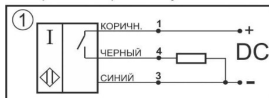
Цоколевка клеммной колодки
