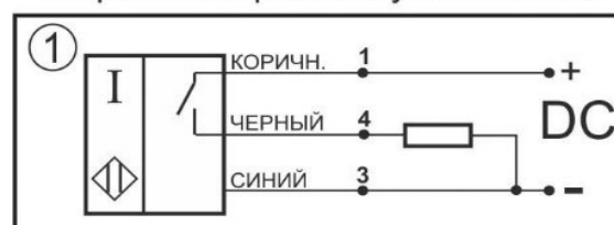
Схема соединения Нормально-разомкнутый контакт
