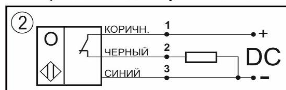
Схема соединения Нормально-замкнутый контакт
