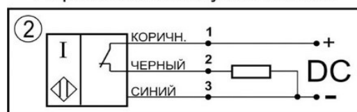
Цоколевка клеммной колодки
