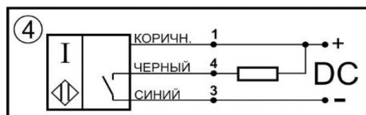
Цоколевка клеммной колодки
