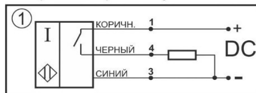
Цоколевка клеммной колодки
