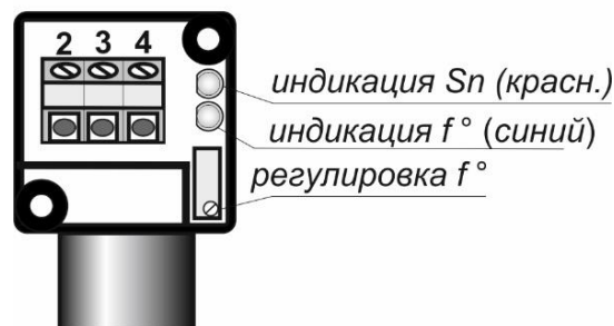
Цоколевка клеммной колодки
