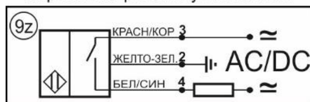
Цоколевка клеммной колодки
