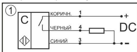
Схема соединения Нормально-разомкнутый контакт
