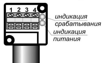
Цоколевка клеммной колодки
