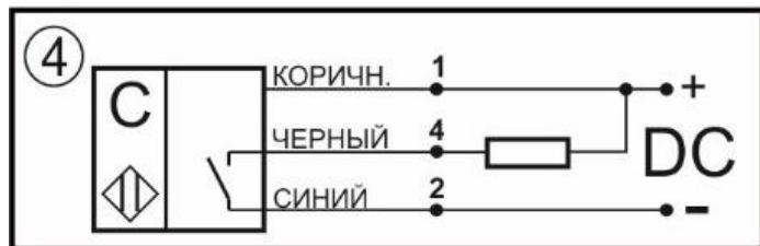
Схема соединения Нормально-разомкнутый контакт
