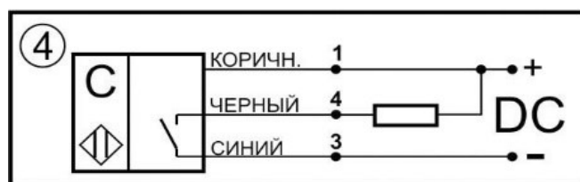
Цоколевка клеммной колодки
