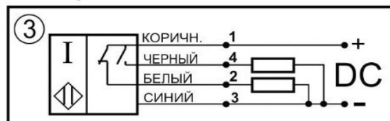
Схема соединения Переключающий контакт
