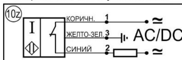
Цоколевка клеммной колодки
