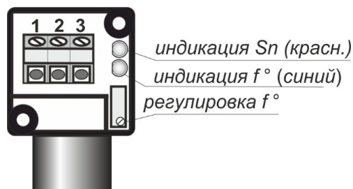
Цоколевка клеммной колодки
