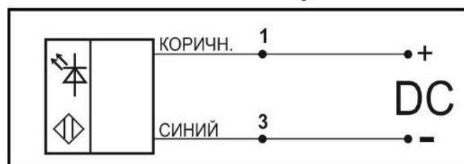
Цоколевка клеммной колодки
