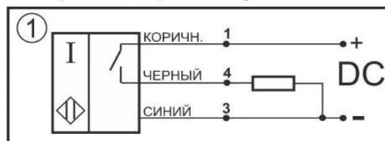
Цоколевка клеммной колодки
