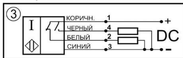
Схема соединения Переключающий контакт
