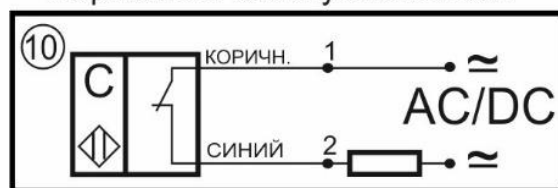
Цоколевка клеммной колодки
