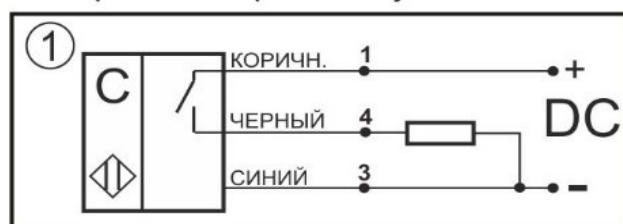
Схема соединения Нормально-разомкнутый контакт
