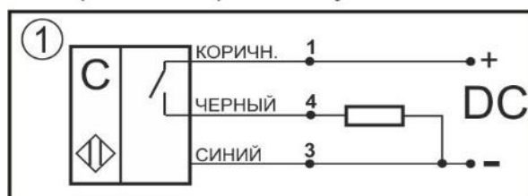
Схема соединения Нормально-разомкнутый контакт
