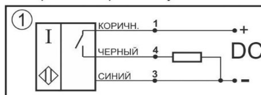
Цоколевка клеммной колодки
