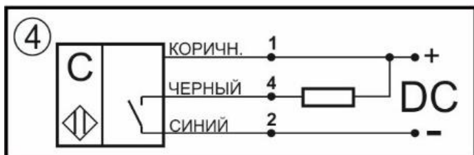
Схема соединения Нормально-разомкнутый контакт
