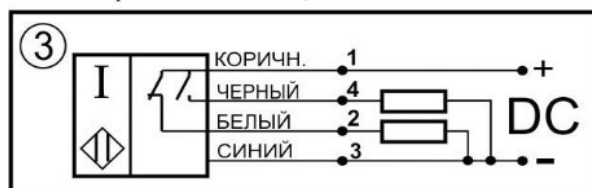
Схема соединения Переключающий контакт
