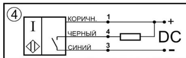
Схема соединения Нормально-разомкнутый контакт
