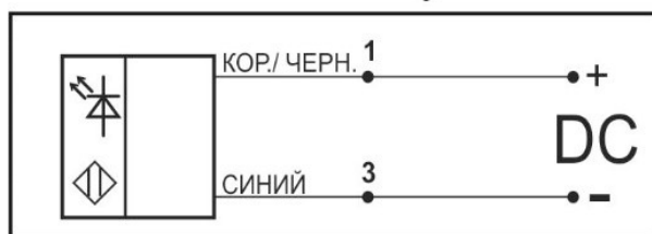
Схема соединения оптического излучателя
