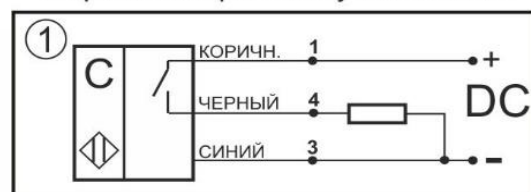
Схема соединения Нормально-разомкнутый контакт
