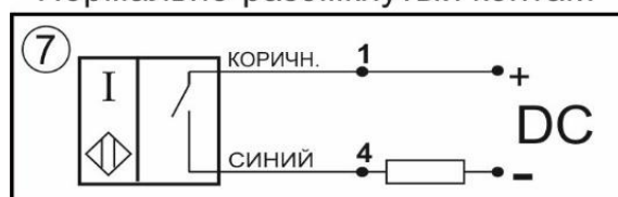
Цоколевка клеммной колодки
