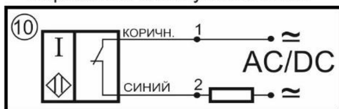
Схема соединения Нормально-замкнутый контакт
