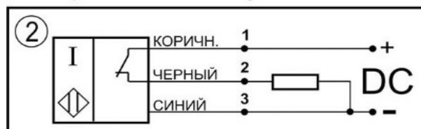
Схема соединения Нормально-замкнутый контакт
