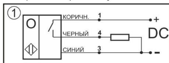
Схема соединения Нормально-разомкнутый контакт
