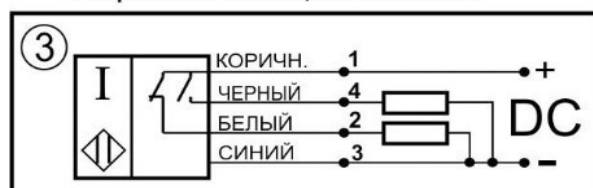
Схема соединения Переключающий контакт
