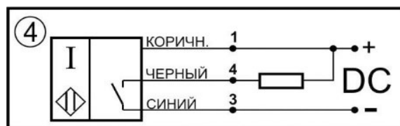
Схема соединения Нормально-разомкнутый контакт
