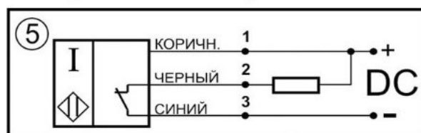
Схема соединения Нормально-замкнутый контакт
