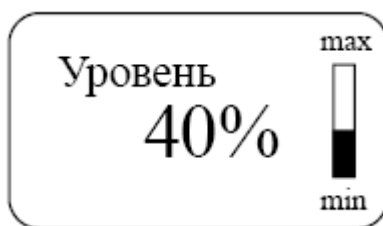
Рис.3 – Основное меню. Отображение информации о уровне заполнения ёмкости
