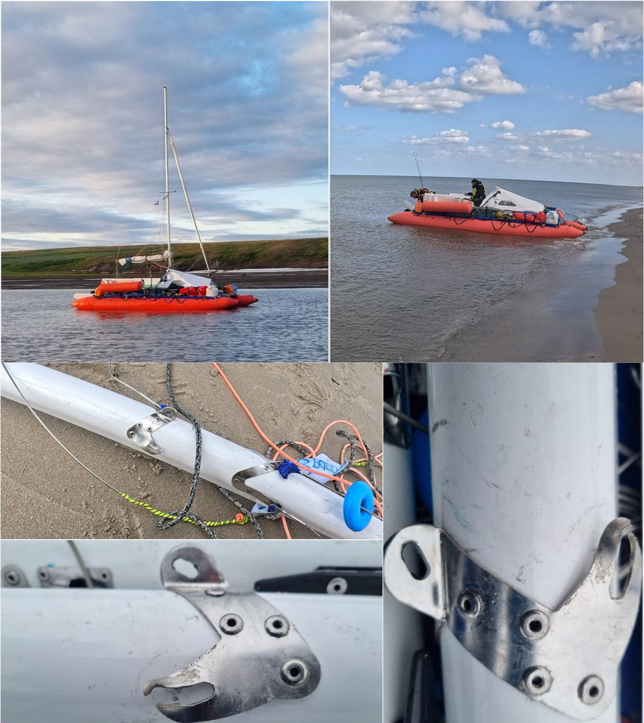
Рис. 59. Мачта есть, а через секунду её уже и нет. 1,5мм-ая разорванная сайлинговая оковка крепления ванты не выдержала ветров и маршрута. По окончании сезона 2024г, перед началом этого и во время сборки на стапеле, все элементы судна внимательно осматривались, в том числе и мачта, включая и отдельные её части. На оковку мачты мы обращали отдельное внимание, проверяли насколько она протёрта и как хорошо держится. На этот момент ранее обращали внимание капитаны в различных тематических чатиках. Никаких проблем визуально не обнаружили, если и были какие-то деформации, то на первые миллиметры в виде незначительных естественных потёртостей. В любом случае, опасений техническое состояние мачты не вызывало. Ванты были набиты достаточно хорошо, за их натяжением мы регулярно следили.
