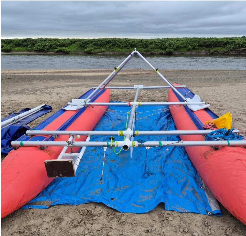
Рис. 8. При сборке судна на песке обычный хозяйственный тент очень помогает не потерять инструмент и мелкие элементы катамарана.
