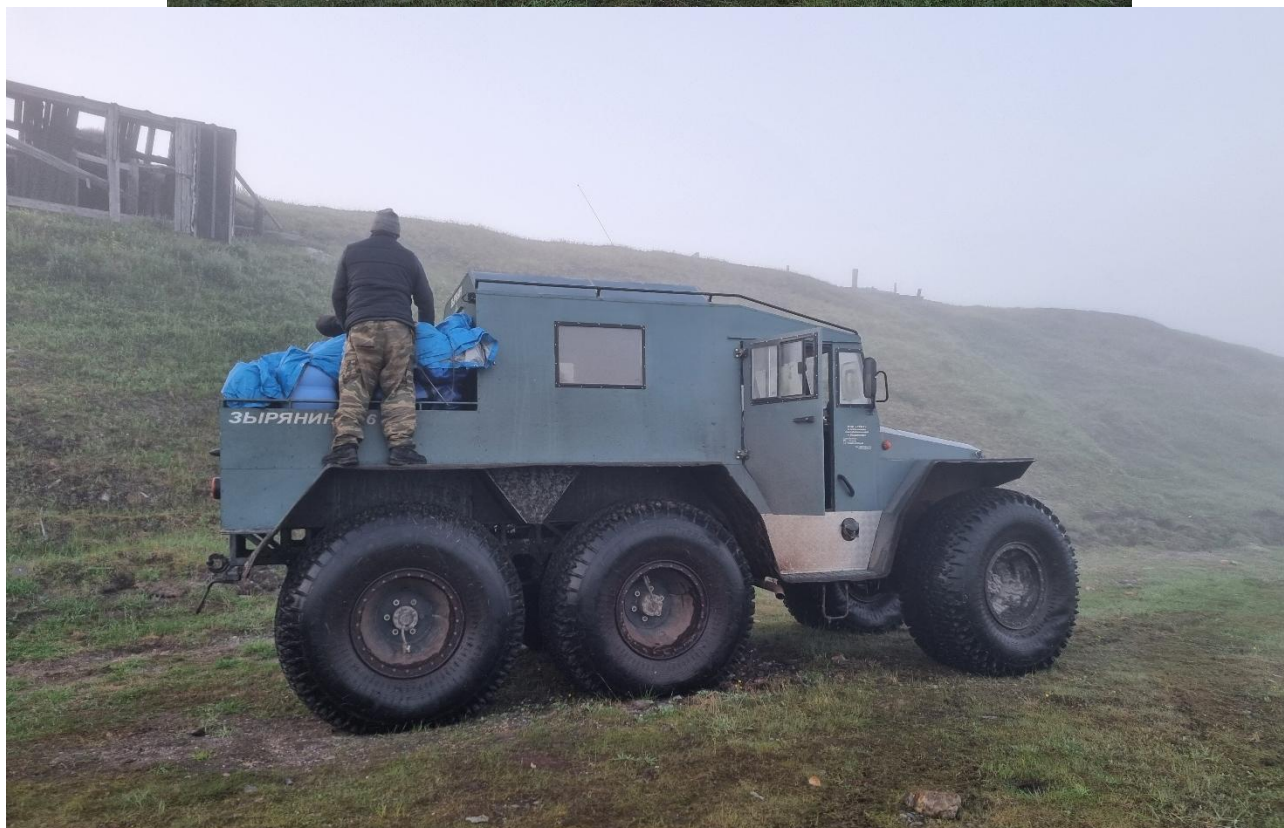
Рис. 69. Трёхосный трекол «Зырянин» с багажным отсеком способен перевезти не менее 1т груза, что позволило нам уехать в одну ходку. Основная масса треколов берет на борт не более 600-800кг, включая пассажиров. При общей массе экипажа и груза в 800кг, нам требовалось 2 трекола (на одном все ехать отказывались), что потенциально увеличивало ценник на поездку в два раза.
