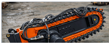
Траншекопатель EXA-HDT 1200 Для погрузчиков и тракторов
