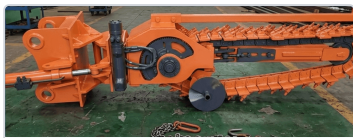
Траншекопатель EXA-XHD 1500 Глубина до 1500 мм
