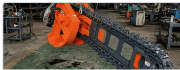
Траншекопатель EXA для Bobcat Для Bobcat S70–S850
