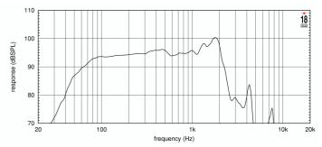
FREQUENCY RESPONSE CURVE MADE ON 125 LIT. ENCLOSURE TUNED 50HZ IN FREE FIELD (4PI) ENVIRONMENT. ENCLOSURE CLOSES THE REAR OF THE DRIVER. FREE AIR IMPEDANCE MAGNITUDE CURVE
