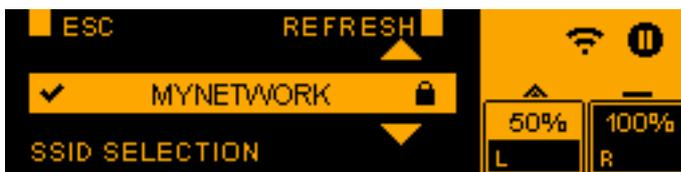
Затем на дисплее отображаются доступные сети. Возле названий зашифрованных сетей отображается значок в виде замка.
