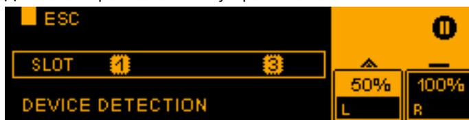
Выполняется распознавание устройства, на дисплее отображается, в каком гнезде расширения обнаружено устройство с протоколом управления коммуникацией.
