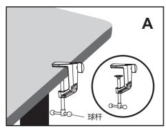
首先通过旋转球杆将夹块固定在桌子上。
