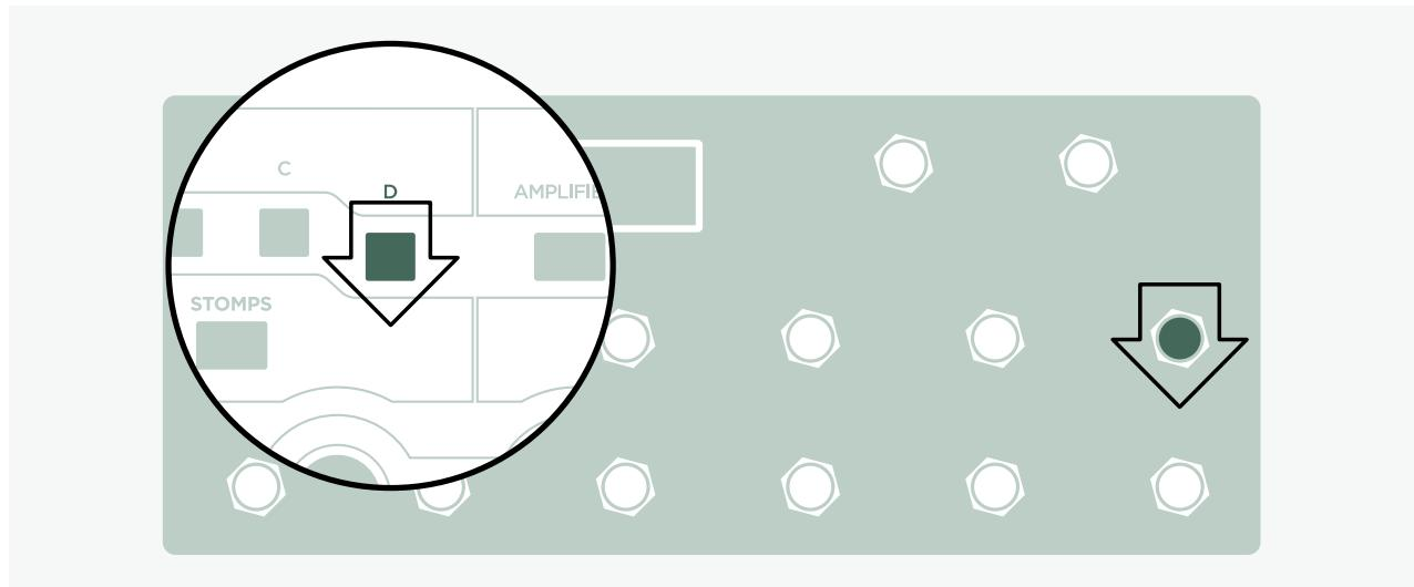
Das Zuweisen von Schaltfunktionen zu den Effekttastern ist denkbar einfach: Halten sie einen der Effekttaster auf der Remote (z. B. Effekttaster III) und drücken sie gleichzeitig am PROFILER die Taste des Effektmoduls, welches sie schalten möchten (z. B. Modul D). Erledigt!
