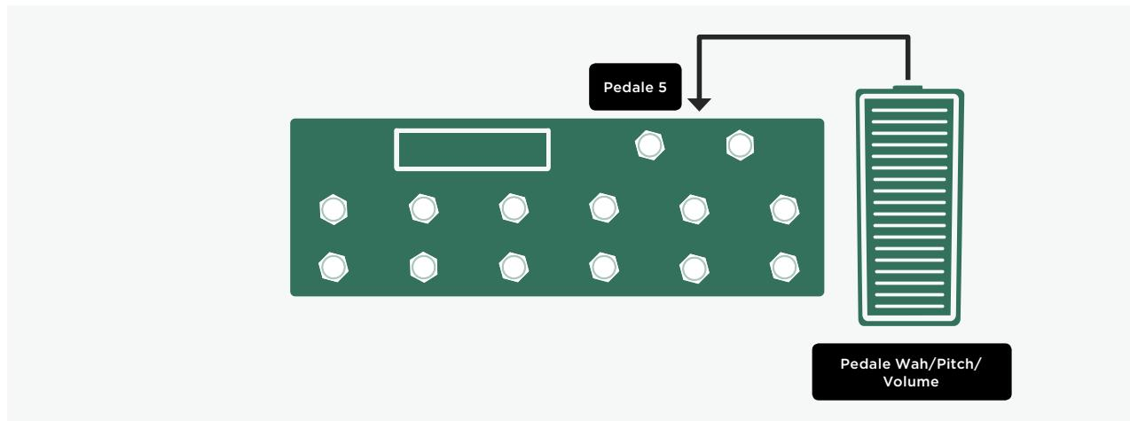
\* Pedale del Wah che controlla anche Intonazione e Volume (“WahPedal to Pitch” e “WahPedal to Volume”);
