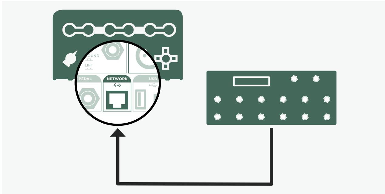
Branchez le PROFILER™ et le contrôleur Remote avec l'excellent câble Ethernet fourni. La fiche Neutrik® Ethercon® du câble garantit une connexion robuste et verrouillable avec le PROFILER Remote.
