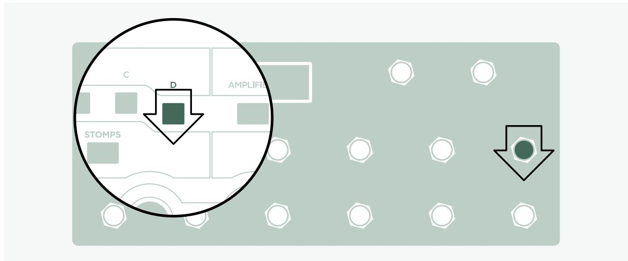
Il est très simple d'assigner des fonctions de commutation aux boutons d'effet: maintenez un bouton d'effet enfoncé sur le pédalier Remote (le bouton IIII, par exemple) et appuyez simultanément sur le bouton du module voulu (le module D, par exemple) en façade du PROFILER. C'est tout!
