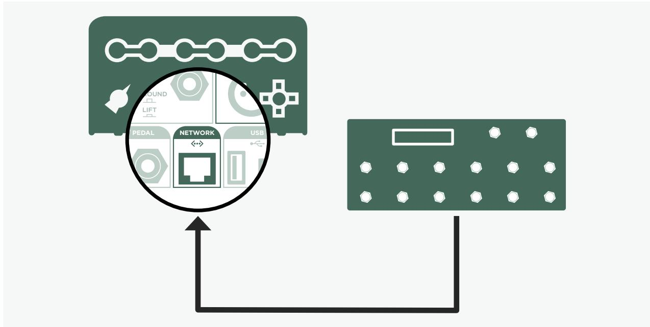
Conecta el PROFILER™ y el Remote mediante el cable Ethernet de alta calidad incluido en el paquete. El portador del conector del cable Neutrik® Ethercon® establece una conexión sólida y bloqueable con el PROFILER Remote. Cuando actives el PROFILER, ambas unidades se activarán simultáneamente. Durante la activación, el Remote se actualizará e inicializará automáticamente.
