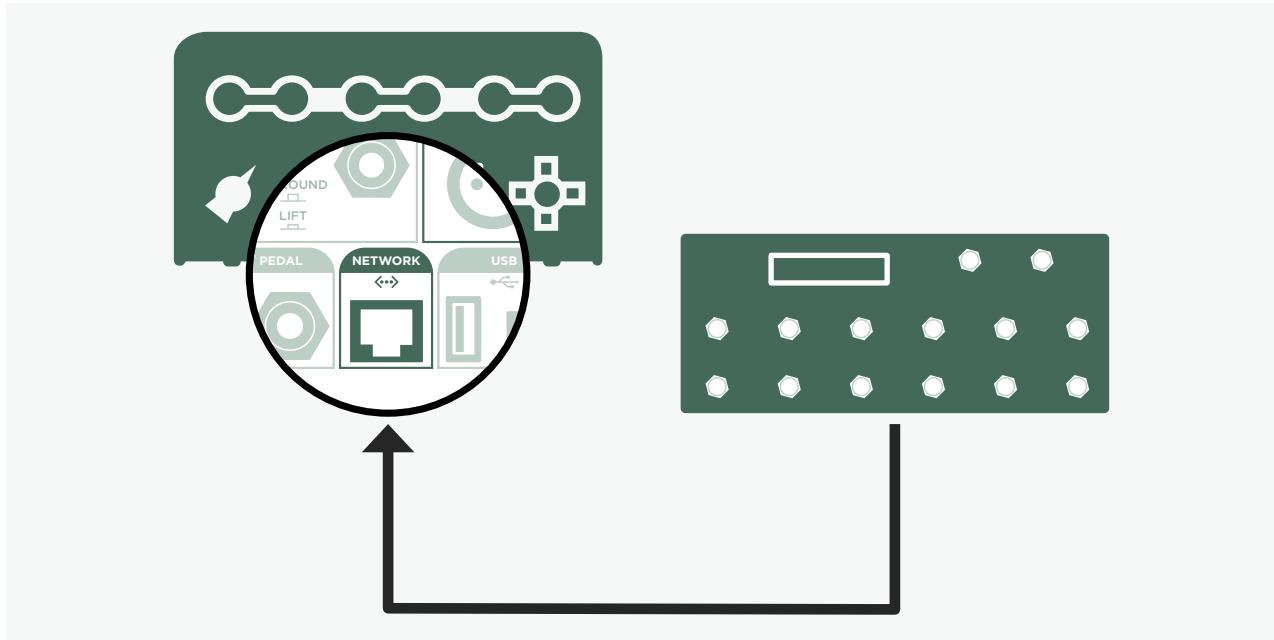
Bitte verbinden sie PROFILER und Remote mittels des mitgelieferten hochwertigen Ethernet-Kabels. Der Neutrik® etherCON® Stecker stellt eine stabile und verschließbare Verbindung mit der PROFILER Remote her.
