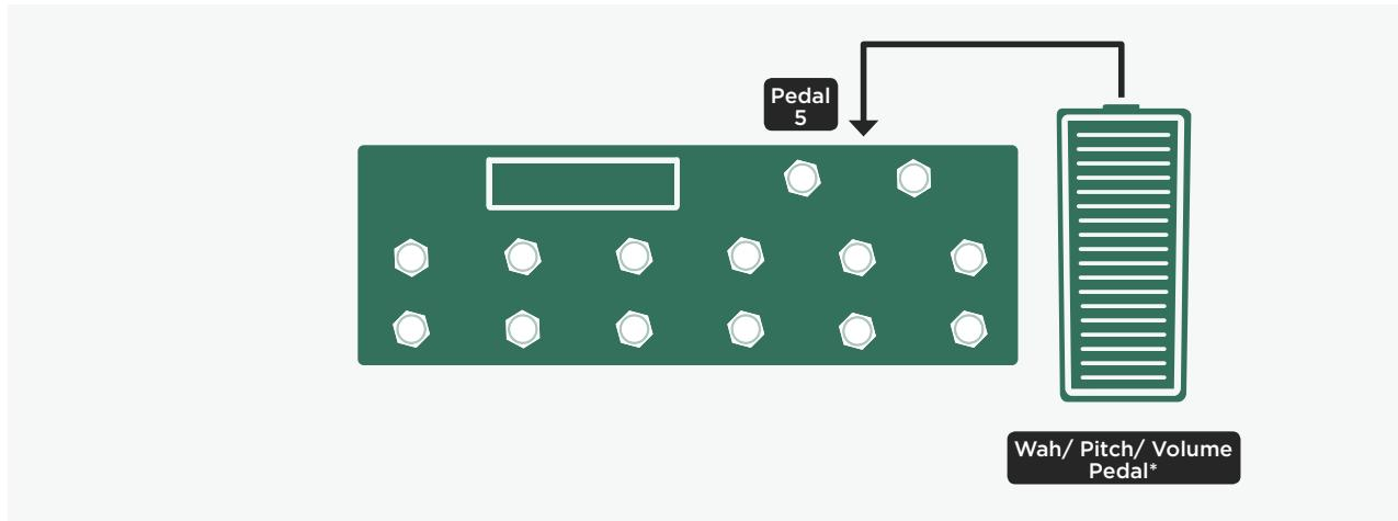
\* Das Wah Pedal kontrolliert Tonhöhe und Lautstärke („WahPedal to Pitch“ und „WahPedal to Volume“). Morphing wird durch den Taster ausgelöst.
