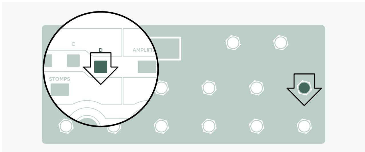
Asignar funciones de conmutación a los botones de efectos es sencillo: basta con mantener pulsado un botón de efecto en el Remote, por ejemplo el botón de efecto 4, y pulsar simultáneamente el botón del módulo deseado, por ejemplo el Módulo D, en el panel frontal del PROFILER. ¡Listos!
