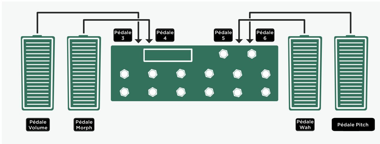
Le contrôleur Remote dispose de 4 prises TRS “PEDAL 3”~“Pedal 6” permettant de brancher des pédales d'expression. Vous pouvez leur assigner des fonctions avec les “System Settings” du PROFILER, comme décrit dans le chapitre consacré aux pédales d'expression et commutateurs au pied du manuel principal ainsi que dans le tutoriel vidéo “Expression Pedals”.
