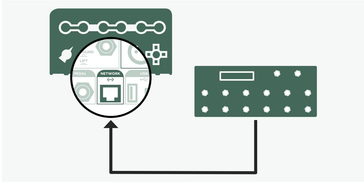
Collegate i vostri PROFILER™ e Remote tramite il cavo ethernet di alta qualità fornito nella confezione. Il connettore Neutrik® Ethercon® stabilisce un collegamento stabile e robusto con il PROFILER Remote.
