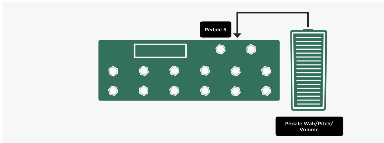
\* Pédale wah pilotant aussi la hauteur et le volume (“WahPedal to Pitch” et “WahPedal to Volume”); Morphing déclenché par des boutons.
