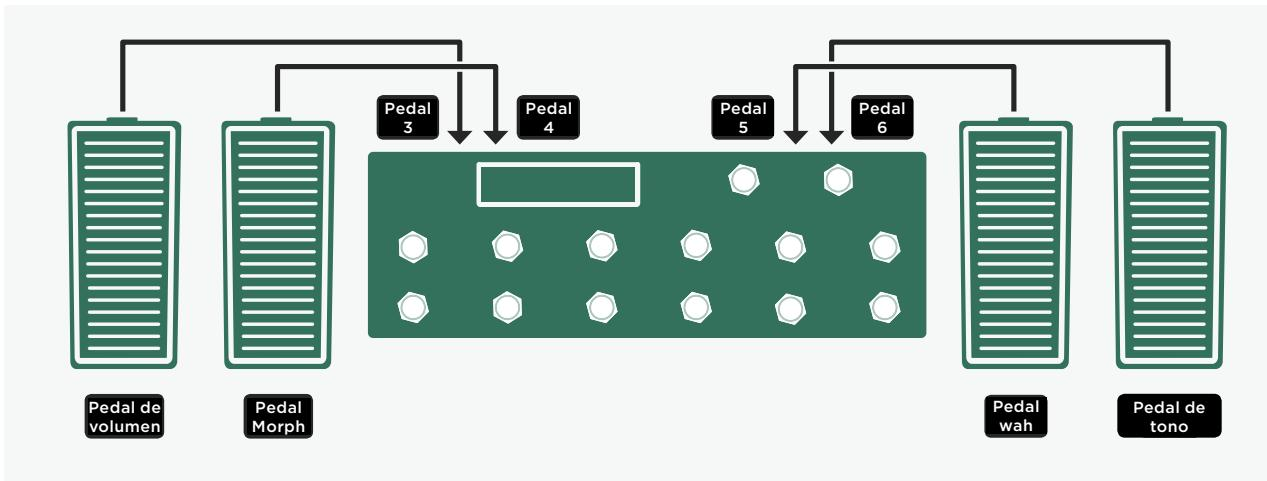
El Remote dispone de cuatro zócalos TRS llamados “PEDAL 3” a “Pedal 6” para conectar pedales de expresión. Sus funciones pueden asignarse en los System Settings del PROFILER, tal como se describe en el capítulo “Pedales de expresión y conmutadores de pedal” del Manual Principal y en el tutorial en vídeo “Expression Pedals”.
