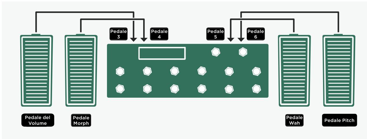
Per collegare pedali di espressione, il Remote dispone di quattro connettori TRS denominati da “PEDAL 3” a “Pedal 6”. La loro funzione può essere stabilita nelle System Settings del PROFILER, come descritto nel capitolo “Pedali di Espressione e Pedali Interruttori” del Manuale Principale e nel tutorial video “Expression Pedals”.
