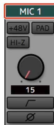
Отображение названия канала. Дважды щелкните этот элемент, чтобы изменить название канала. Метки каналов могут иметь длину до десяти символов.
