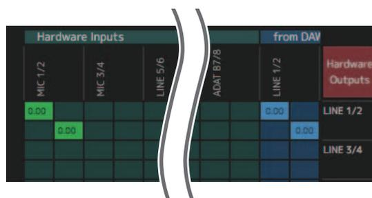
Если в этом состоянии настройка панорамирования переместится в крайнее левое положение, сигнал, отправляемый вправо, будет остановлен, и соответствующая область сетки справа автоматически отключится.
