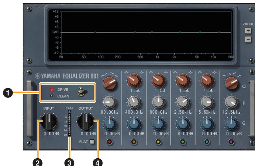
Для моделирования характеристик искажений, свойственных аналоговым анализаторам, использованным в 70-е годы, в Equalizer 601 применяется обработка цифровых сигналов (эффекты VCM) на основе собственной технологии Yamaha VCM (виртуальное моделирование цепи). Аудиосигнал получает насыщенный эффект искажения.
