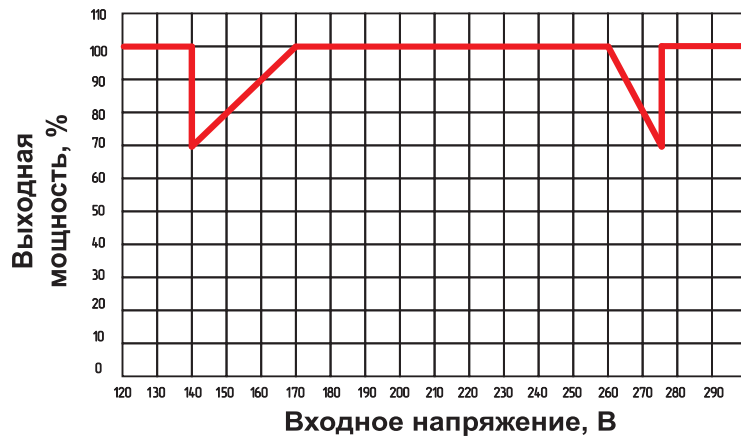
Рис. 1 График зависимости мощности от напряжения
