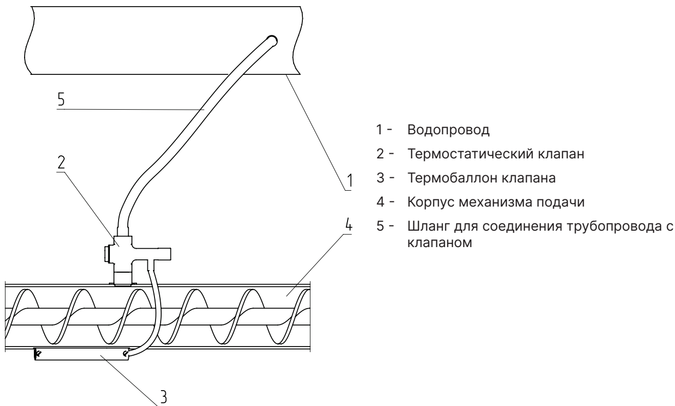
Рис.4 Система охлаждения топливопровода
